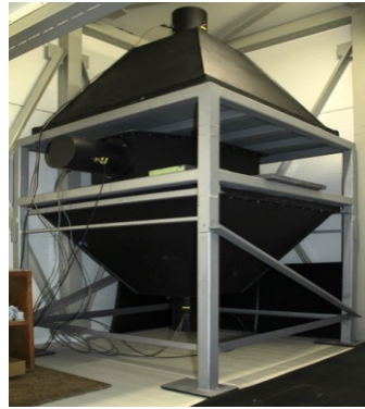
SEVAN Detector in Lomnický štít, Slovakia; Latitude: 49° 11' 42.53" N Longitude: 20° 12' 47.43" E Altitude: 2633 m. a.s.l. Rc : 3.88 GV
