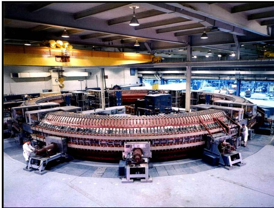
**Cosmotron:** 1<sup>st</sup> proton synchrotron.
