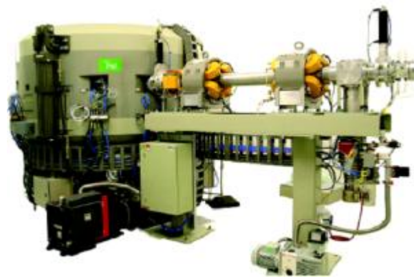
C18/18 IBA ցիկլոտրոնը, որն օգտագործվում է բժշկական իզոտոպներ արտադրելու համար
